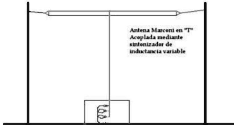
Ejemplo de cálculo elemental de una antena MARCONI: Calcular la longitud de una antena con iguales valores que el caso anterior  $f = 6 \text{ Mhz}$ .
