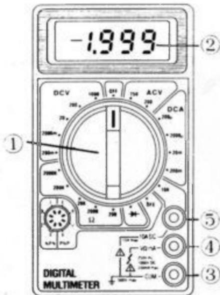
El **Multímetro** agrupa las funciones de amperímetro, voltímetro y ohmetro en un solo instrumento de medición.
